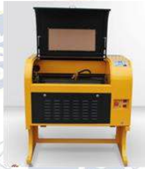
ภาพที่ 1 เครื่องซีเอ็นซีเลเซอร์ขนาดพื้นที่ทำงาน 60X40 เซนติเมตร
