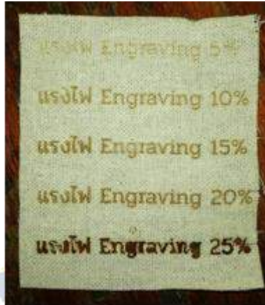
ภาพที่ 5 การสร้างลวดลายบนผ้าด้วยด้วยแรงวัตต์ (watt) ที่ต่างกัน
