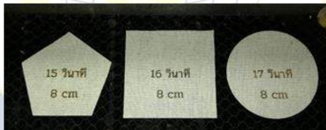
ภาพที่ 4 การตัดผ้าฝ้ายด้วยเครื่องซีเอ็นซีเลเซอร์ในรูปทรงพื้นฐาน
