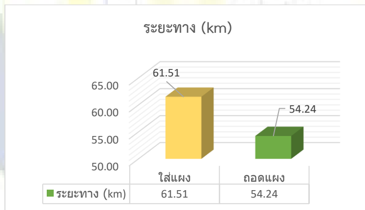
ภาพที่ 8 การเปรียบเทียบระยะทางสูงสุดที่วิ่งได้ระหว่างยานยนต์ไฟฟ้าขนาดเล็กที่ติดตั้งแผงโซลาร์เซลล์ และไม่ได้ติดตั้งแผงโซลาร์เซลล์
