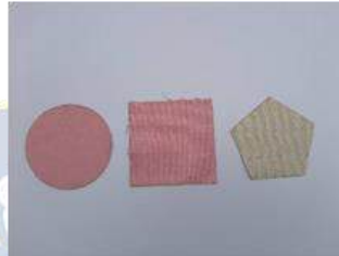
ภาพที่ 3 ผ้าฝ้ายรูปทรงพื้นฐานจากการตัดด้วยแสงเลเซอร์
