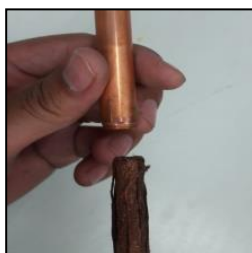
ภาพที่ 3 ท่อความร้อน และวัสดุพูนแบบตาข่าย
