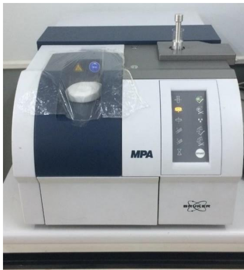
ภาพที่ 1 การเก็บข้อมูลเนียร์อินฟราเรดด้วยเครื่อง FT-NIR spectrometer (MPA, Bruker, Germany)
