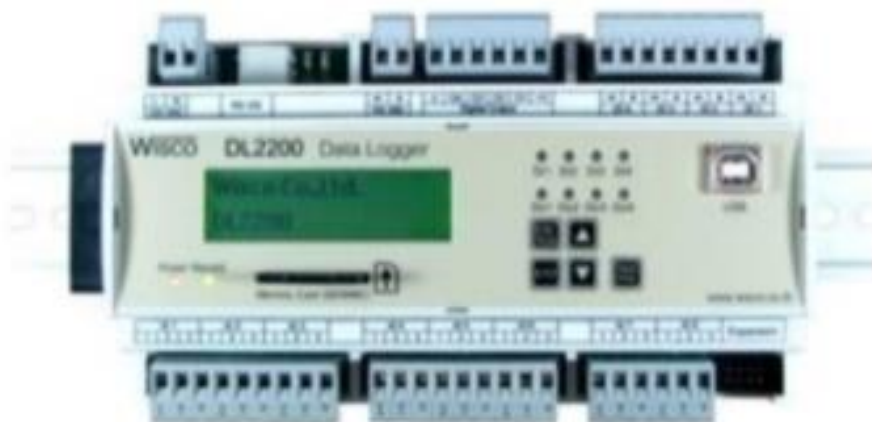
ภาพที่ 6 เครื่องบันทึกอุณหภูมิ (Data-logger)
