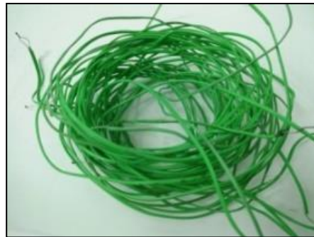
ภาพที่ 4 สายเทอร์โมคัปเปิลยี่ห้อ OMEGA ชนิด K
