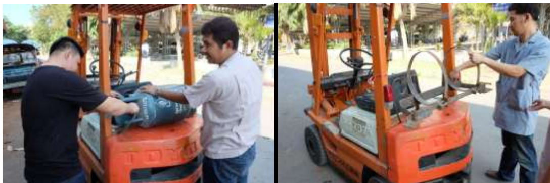
ภาพที่ 4 การทดลองการใช้แก๊สชีวภาพและดำเนินการติดตั้งที่วางถังแก๊ส
