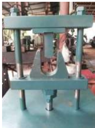
ภาพที่ 3 แสดงชุดกดอัดชิ้นงานตามวิธีการดัดโค้งแบบ Mandrel and Support
