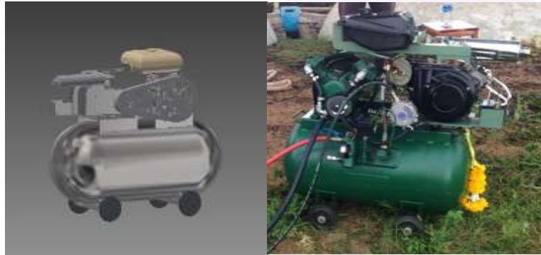
ภาพที่ 2 แบบชุดบรรจุแก๊สชีวภาพโดยใช้เครื่องยนต์เบนซินขนาด 5.5 แรงม้า
